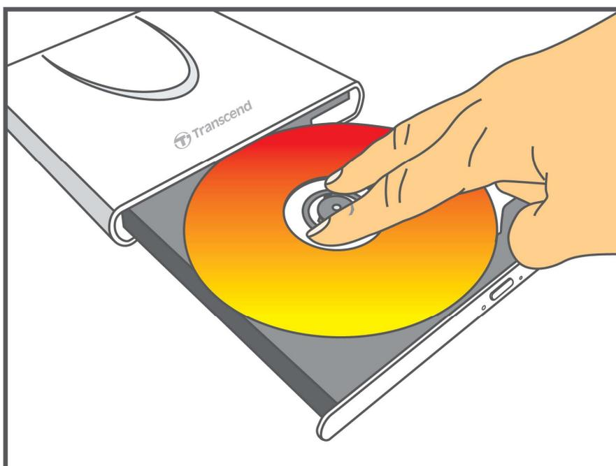
5. 轻推光盘托盘回去. 若完全关闭的时候, LED 指示灯将会闪烁。
