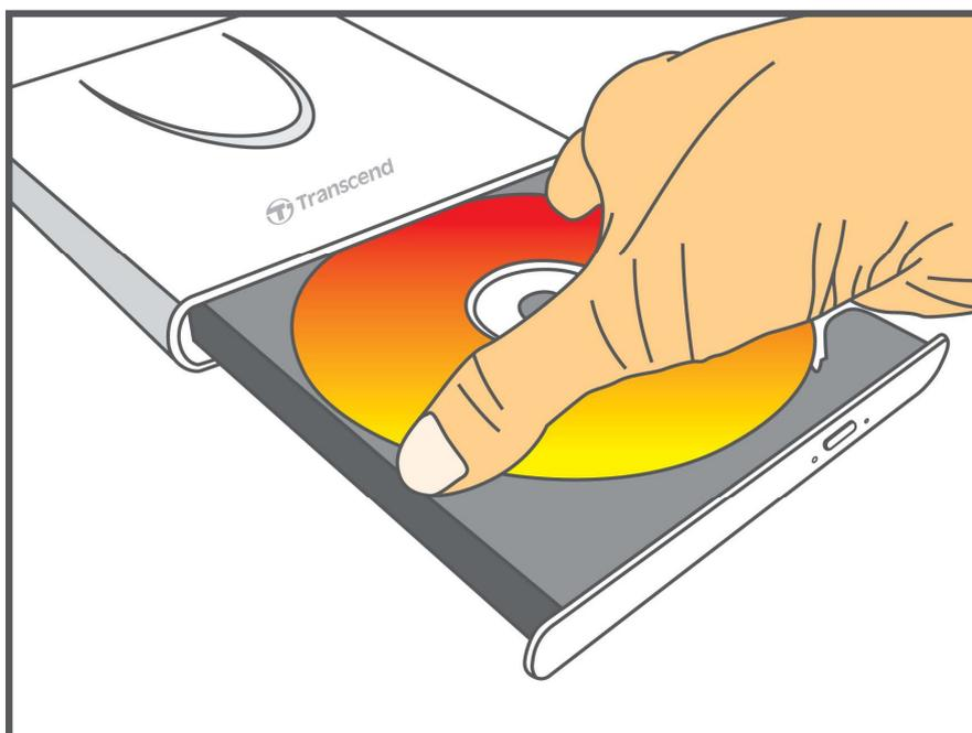
4. При помощи двух или более пальцев, нажмите на центральную часть диска до тех пор, пока он не встанет на свое место.
