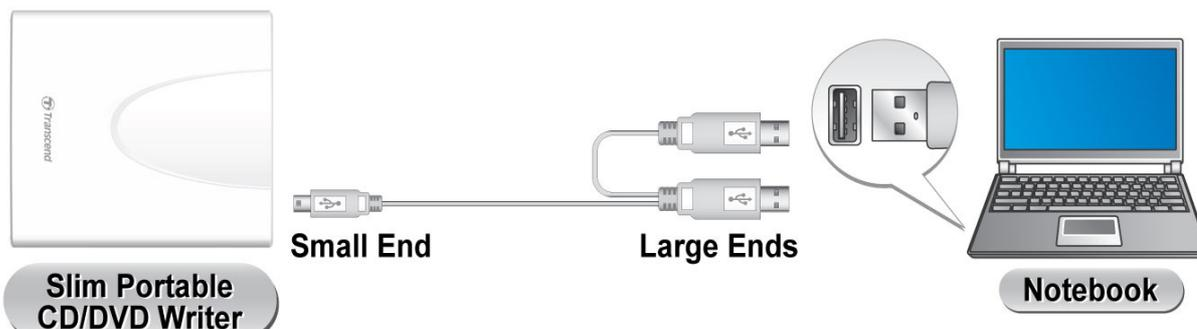
**Примечание:** Подключите пишущее устройство CD/DVD к двум портам USB на компьютере с помощью прилагающегося кабеля USB.
