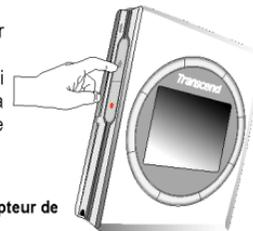
Fig 6: Appuyer et maintenir l'interrupteur de mise en marche/arrêt.
