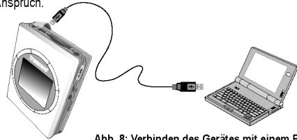
Abb. 8: Verbinden des Gerätes mit einem PC
