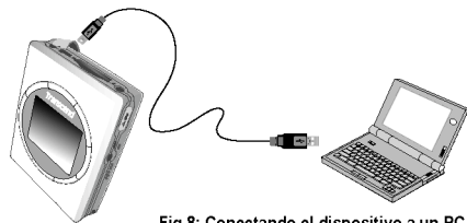
Fig 8: Conectando el dispositivo a un PC
