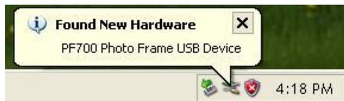
数码相框现在已经可以传输数据。新的**卸除式磁盘驱动器**及其新赋予的磁盘代号将出现在**我的电脑**中代表不同的存储卡插槽(包含内置内存), 您可以将数据拖曳到这些卸除式磁盘驱动器或文件夹中进行数据传输。
