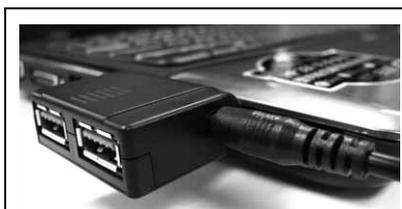
**Per assicurarsi il corretto funzionamento del dispositivo USB, controllare sempre che il cavo d'alimentazione USB sia connesso all'Adattatore USB3.0 ExpressCard.**
