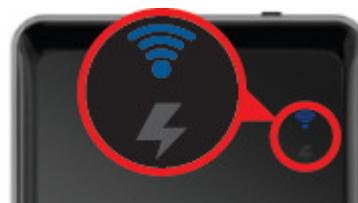
La diode DEL clignote en rouge: 25% d'autonomie disponible. La diode s'allume en rouge vif quand le niveau d'autonomie passe la barre des 20%. Quand vous utilisez l'App, un message pop-up apparaît pour indiquer un niveau faible de batterie.
