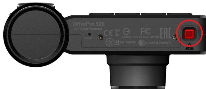
**수동 이벤트 녹화:** 녹화 중, 제품 하단의 이벤트 녹화 버튼을 누르면 수동으로 이벤트 녹화가 시작됩니다. 이벤트 녹화가 시작되면, 본 제품의 화면에 이벤트 녹화 메시지 창이 표시됩니다.
