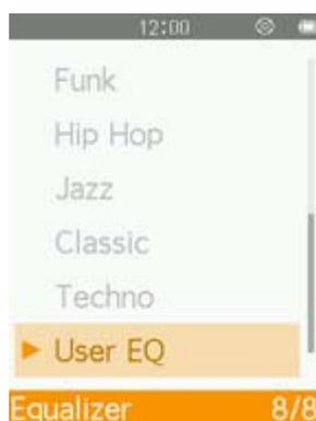
4. Drücken Sie
